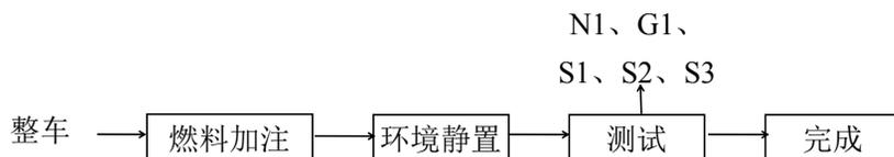
图 3.6-2 整车测试工艺及产污流程图
