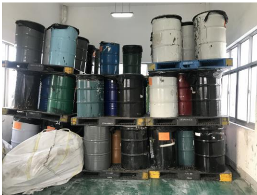
图 3 分类收集暂存、标识牌及地面防渗
