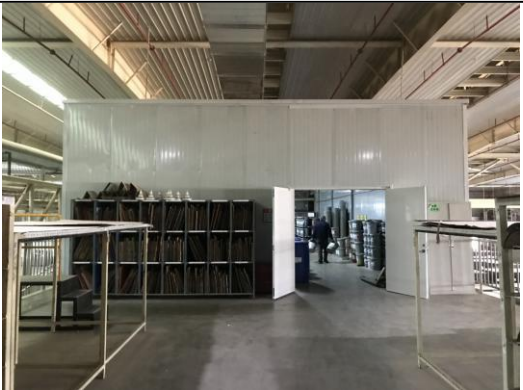
图 8 二层平台油墨配墨、储存区域、印版 存储区域密闭收集
