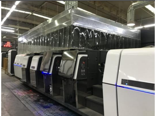
图 7 印刷机集气罩+软帘
