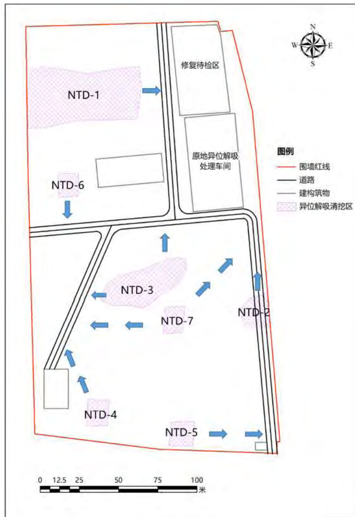
图 5.3-4 污染土壤清挖运输路线示意图
