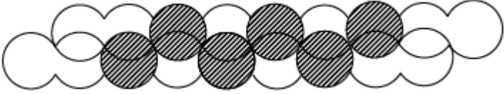
图 5.2-2 双排三轴搅拌桩施工接头示意图
